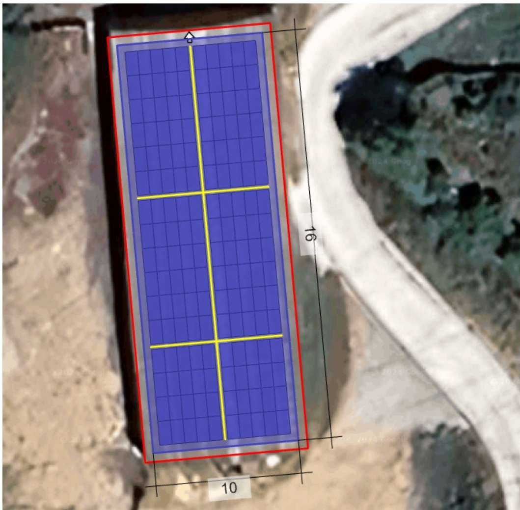
Figura 13: Simulación instalación fotovoltaica sobre la cubierta estudiada.
